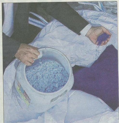
Une fois délestés de leurs élastiques, de leur barrette nasale et de leurs fils, les masques chirurgicaux sont broyés puis fondus afin d’être transformés en granulés. Photo Progrès/Pierre-Yves ROYET
